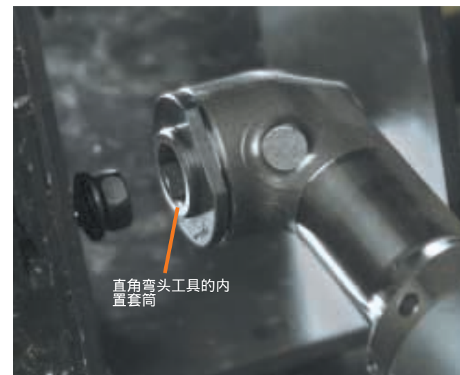
在弯头扳手中内嵌式套筒
